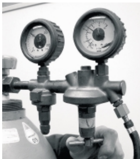
Joonis 5.22. Gaasiballoonides mõõdetakse rõhku metallmanomeetriga
